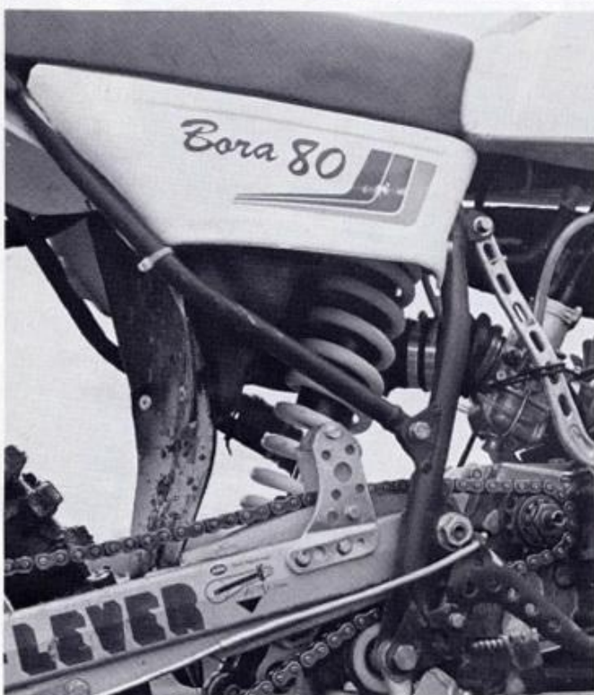
Oben: Le Lieu-Bremse im Vorderrad Mitte: Saubere Kettenführung und stabile Schwinge Unten: White Power-Dämpfer im Heck
